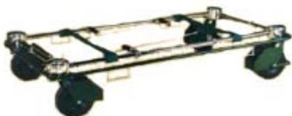
Il carrello ha 4 ruote girevoli con freno e blocco del girevole (vedi particolare in figura a destra), n. 2 sponde laterali di protezione, n. 2 rotaie guida, n. 2 tavole di legno, ed è completo di timone, con le seguenti dimensioni: lunghezza cm. 277, larghezza cm. 125, altezza: cm. 50, interasse ruote cm. 105.
